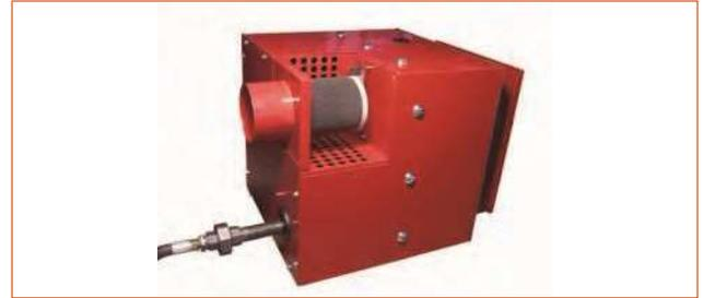
El Redi-Pak es una unidad compacta de operación y control de fácil uso para suministrar una mezcla proporcional de aire y gas de premezcla a los quemadores. Este equipo proporciona una manera simple y económica de agregar quemadores infrarrojos a hornos o líneas de proceso. La unidad se puede configurar para operar uno o dos quemadores con capacidades totales de hasta 150,000 btu / hr (serie RP-100) o 400,000 btu / hr (serie RP-400), al tiempo que cumple con los códigos de la NFPA.
